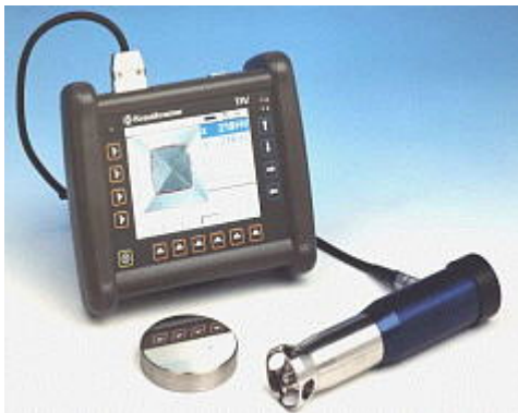
Das Through-Indenter-Viewing-Verfahren (TIV)
